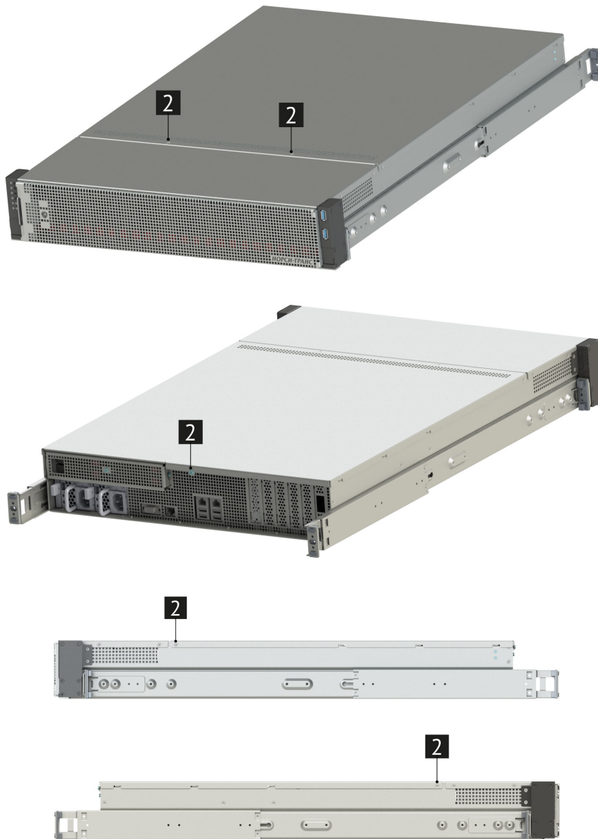
Рис. 21. Установка задней крышки платформы
