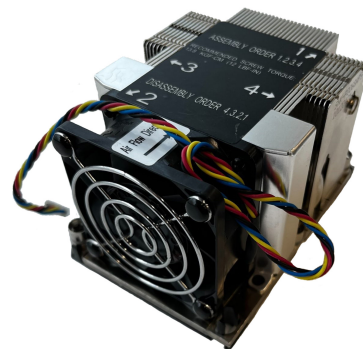
Рис. 33. 2U радиатор с активным охлаждением
