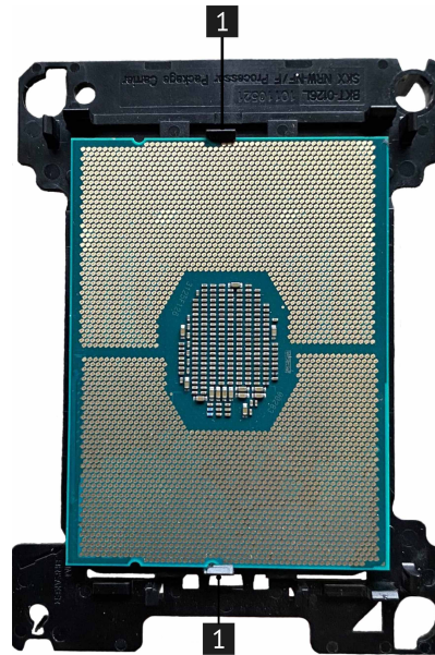
Рис. 37. Снятие процессора с радиатора
