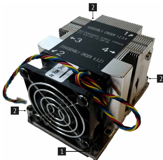
Рис. 40. Снятие процессора с 2U радиатора с активным охлаждением
