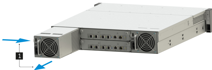
Рис. 51. Извлечение блока питания
