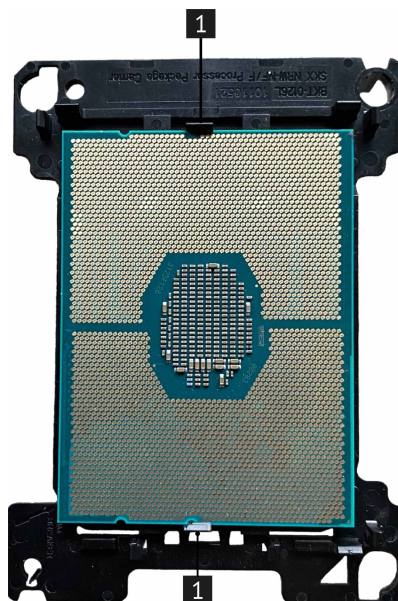
Рис. 37. Снятие процессора с радиатора
