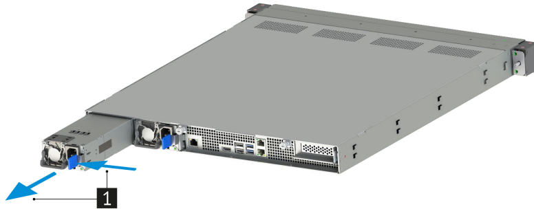
Рис. 46. Извлечение блока питания сетевого хранилища
