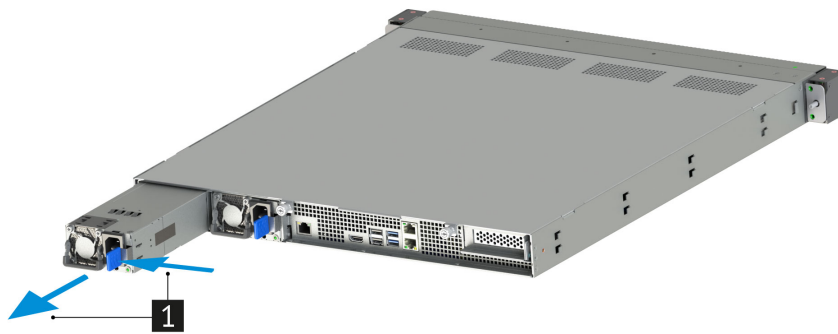
Рис. 44. Извлечение блока питания из сетевого хранилища
