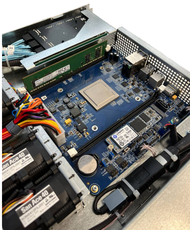
Рис. 29. Извлечение радиатора из сетевого хранилища
