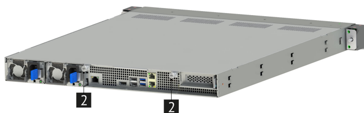
Рис. 20. Установка верхней крышки сетевого хранилища
