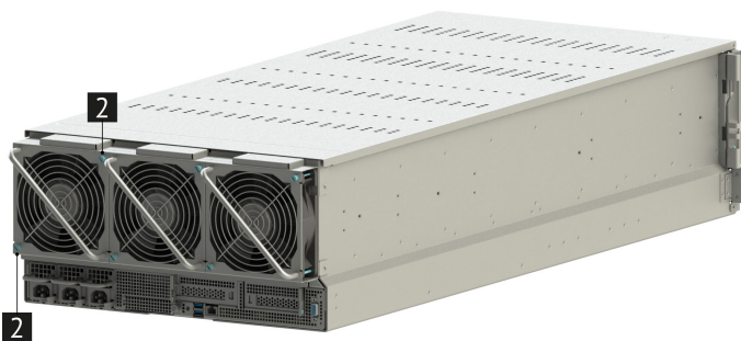
Рис. 32. Подключение наружного вентилятора к корпусу сервера
