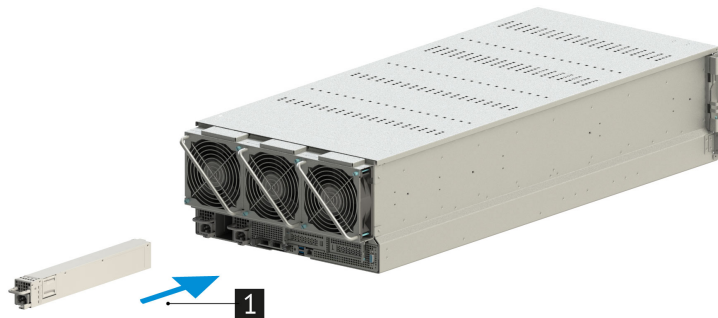
Рис. 59. Установка блока питания в сервер
