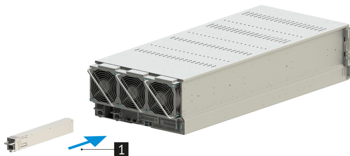
Рис. 61. Установка блока питания сервера
