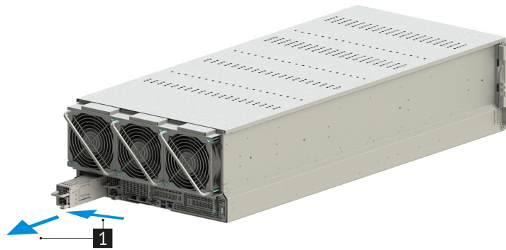
Рис. 58. Извлечение блока питания из сервера
