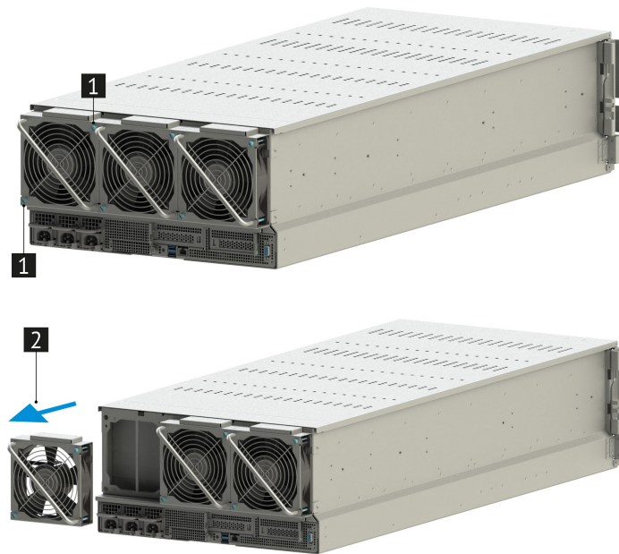
Рис. 31. Извлечение наружного вентилятора сервера
