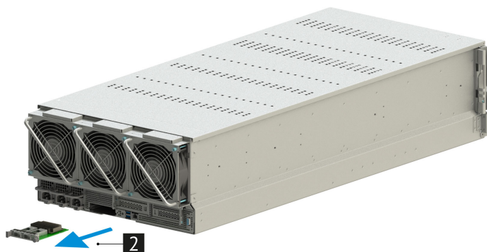
Рис. 53. Извлечение карты OCP 3.0 PCIe x16
