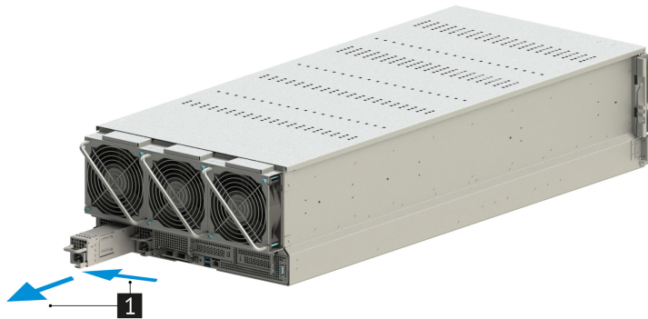
Рис. 60. Извлечение блока питания сервера
