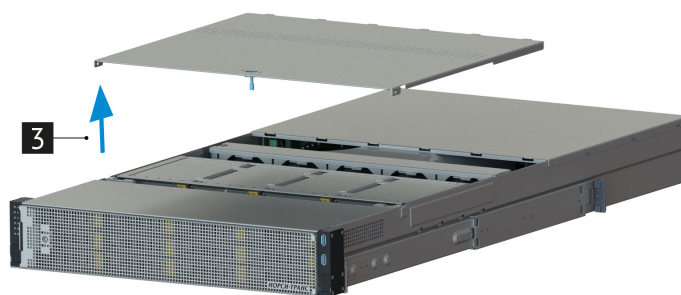
Рис. 21. Снятие средней крышки платформы
