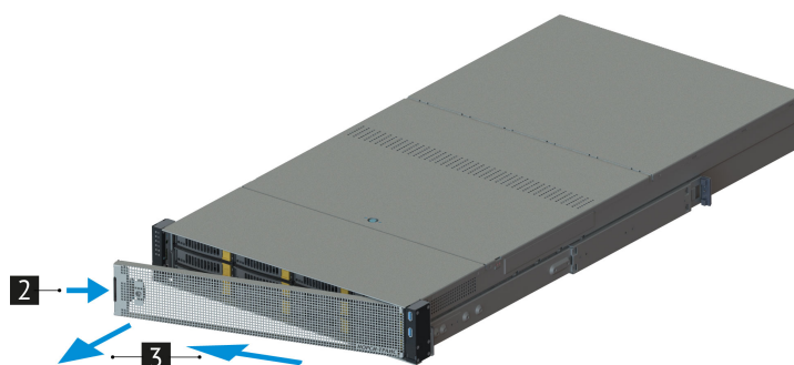
Рис. 18. Снятие передней панели
