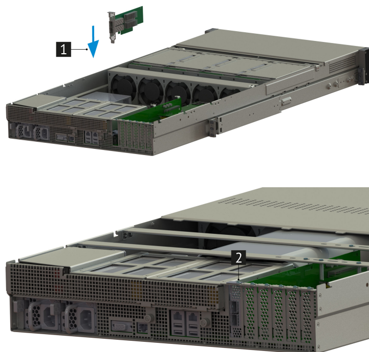
Рис. 56. Установка Карты расширения
