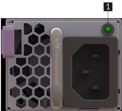
Рис. 61. Светодиодная индикация состояния блока питания
