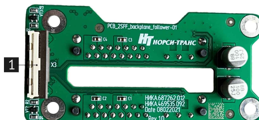
Рис. 12. Плата расширения 2SFF (НИКА.469535.092)
