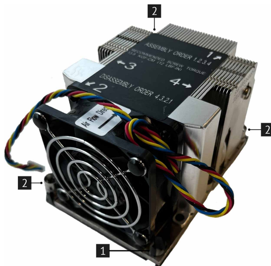
Рис. 45. Снятие процессора с 2U радиатора с активным охлаждением
