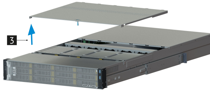
Рис. 21. Снятие средней крышки платформы
