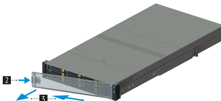
Рис. 18. Снятие передней панели
