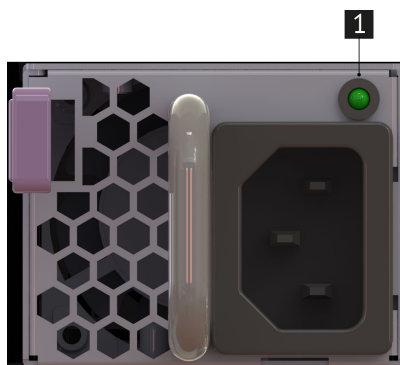
Рис. 61. Светодиодная индикация состояния блока питания
