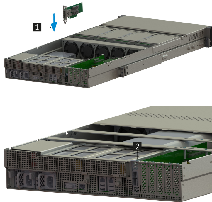
Рис. 56. Установка Карты расширения
