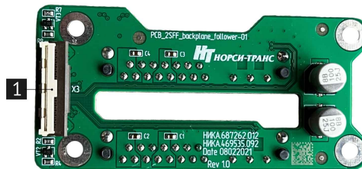
Рис. 12. Плата расширения 2SFF (НИКА.469535.092)
