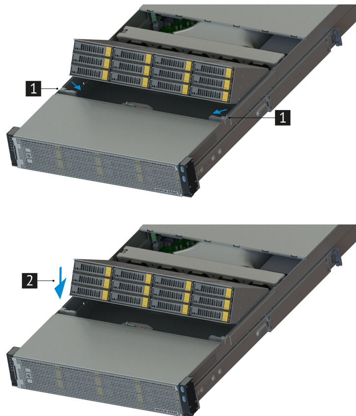
Рис. 24. Установка внутренней дисковой кассеты/поворотной кассеты
