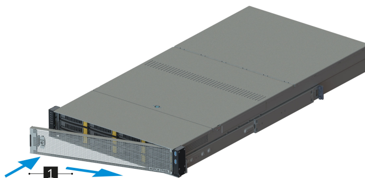
Рис. 19. Установка передней панели
