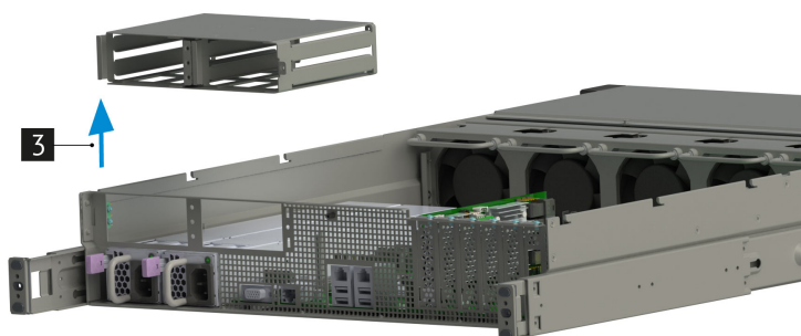
Рис. 22. Снятие каркаса НИКА.301233.012
