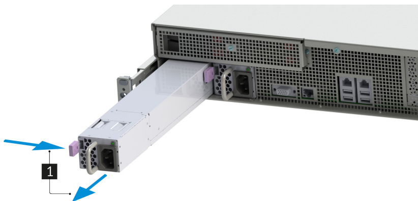
Рис. 50. Извлечение блока питания
