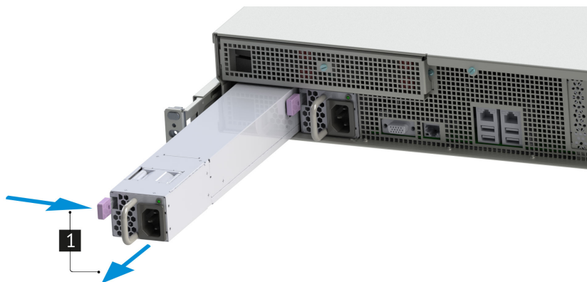
Рис. 48. Извлечение блока питания
