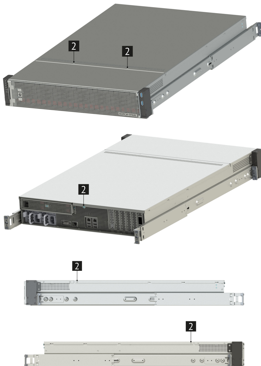
Рис. 21. Установка задней крышки платформы
