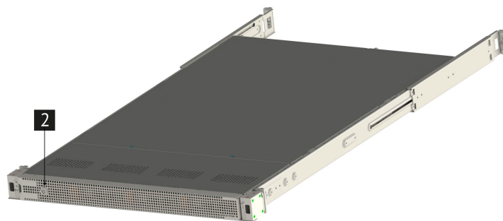
Рис. 19. Закрытие передней панели ключом
