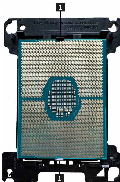
Рис. 35. Снятие процессора с радиатора
