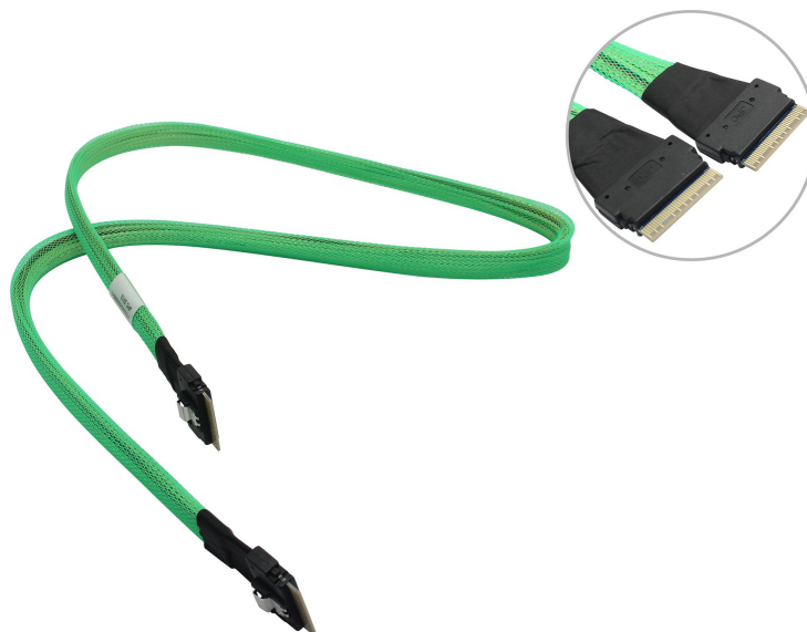
Рис. 44. Внешний вид кабеля SlimSAS-SlimSAS X8-X8
