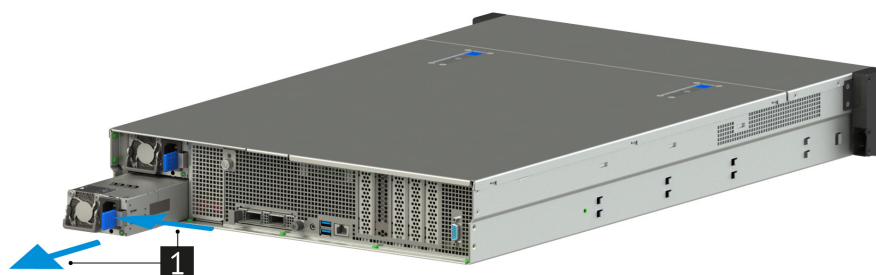
Рис. 61. Извлечение блока питания из сервера
