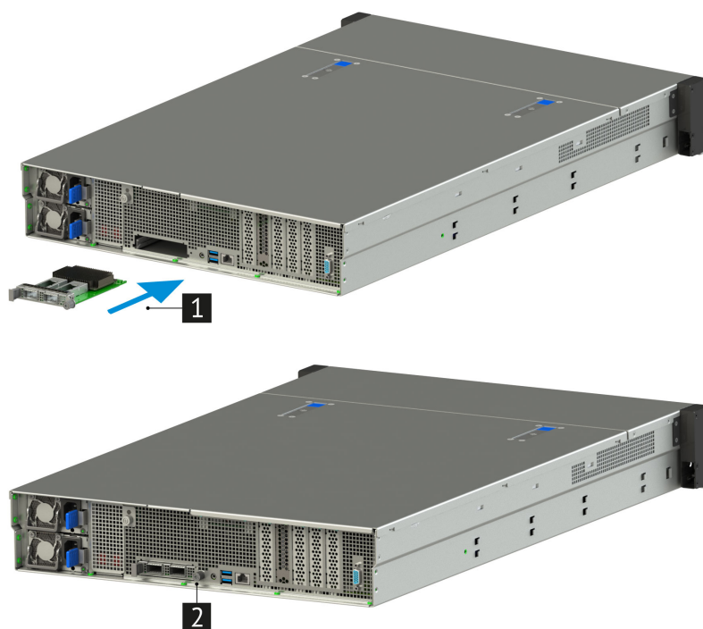
Рис. 59. Установка карты OCP 3.0 PCIe x16
