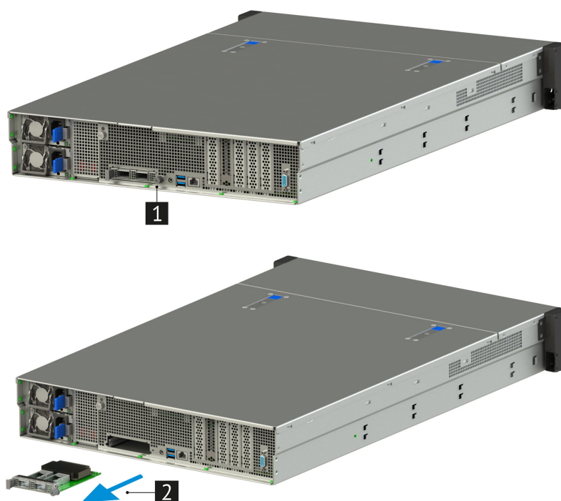
Рис. 58. Извлечение карты OCP 3.0 PCIe x16
