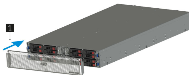
Рис. 32. Установка передней панели с установленными модулями Тип 1
