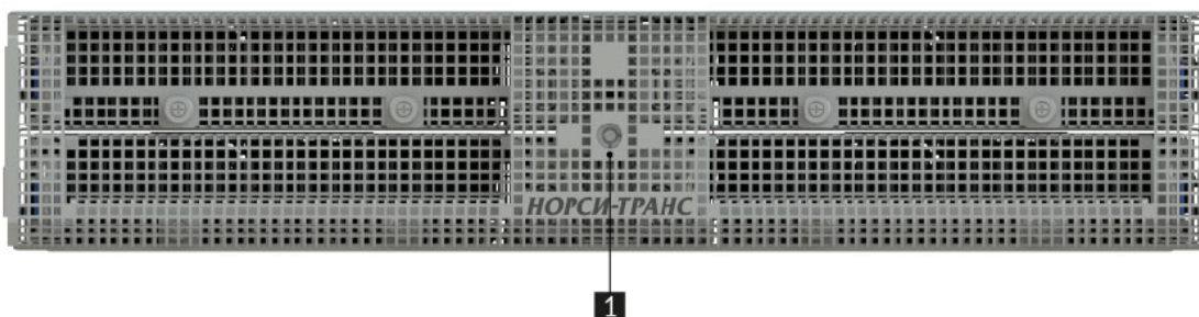
Рис. 28. Открытие передней панели ключом с установленными модулями Тип 3
