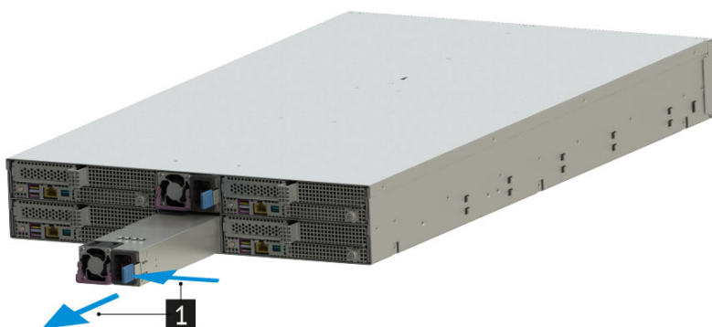
Рис. 92. Извлечение блока питания из сервера
