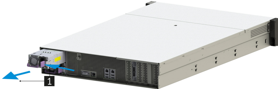
Рис. 55. Извлечение блока питания сервера
