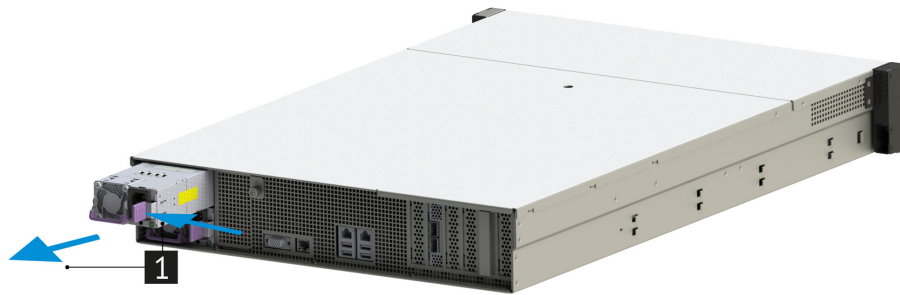
Рис. 53. Извлечение блока питания из сервера
