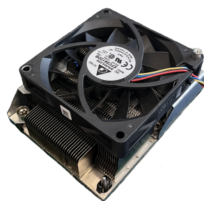
Рис. 35. 1U радиатор с активным охлаждением
