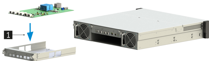
Рис. 31. Установка платы SAS-экспандера
