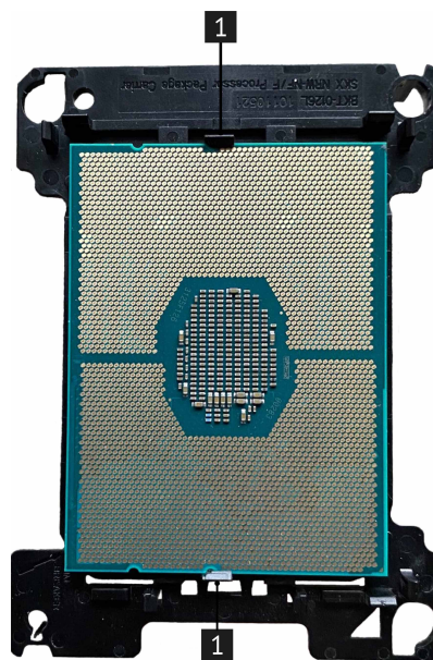
Рис. 43. Снятие процессора с радиатора
