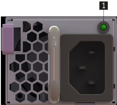
Рис. 61. Светодиодная индикация состояния блока питания
