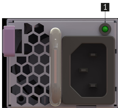
Рис. 61. Светодиодная индикация состояния блока питания
