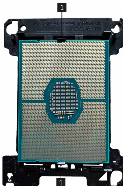
Рис. 46. Снятие процессора с радиатора
