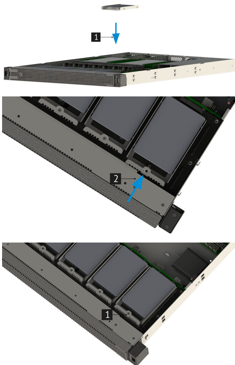
Рис. 47. Установка кассеты с SSD диском
