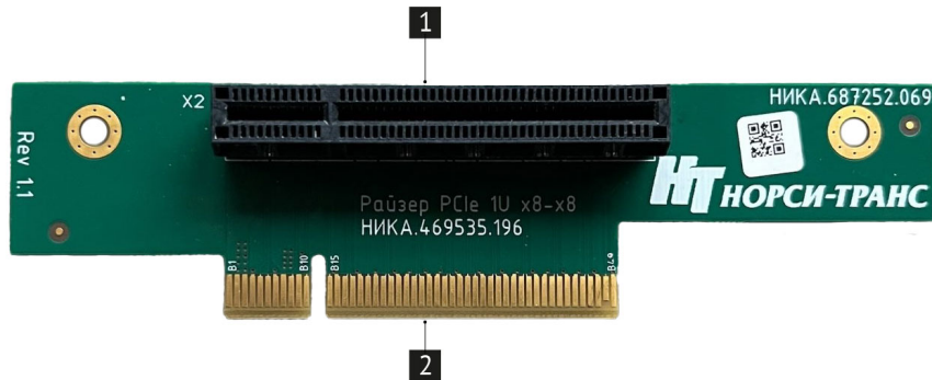
Рис. 13. Райзер PCIe 1U x8-x8 (НИКА.469535.196)
