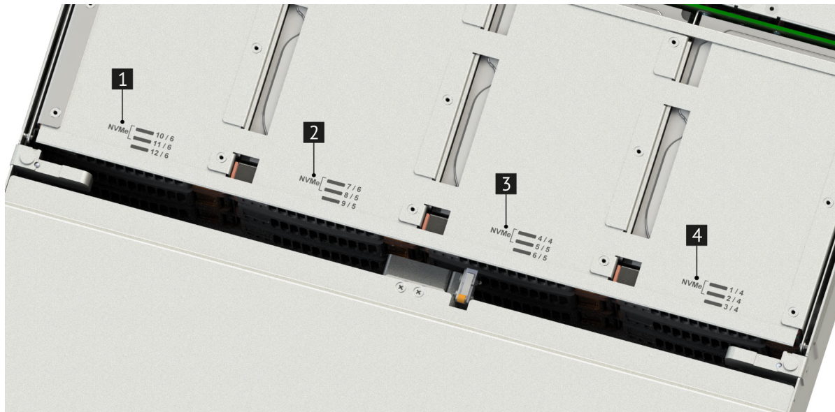
Рис. 60. Место установки NVMe-дисков в сервер
