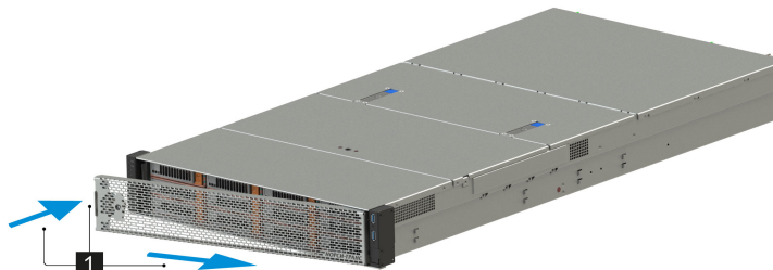
Рис. 21. Установка передней панели
