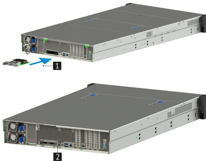
Рис. 70. Установка карты OCP 3.0 PCIe x16
