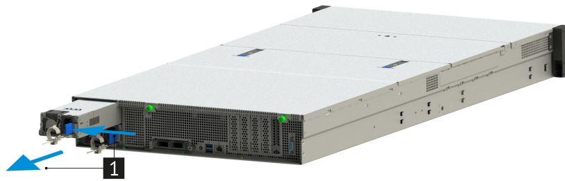
Рис. 72. Извлечение блока питания из сервера
