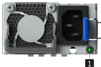
Рис. 71. Светодиодная индикация состояния блока питания
