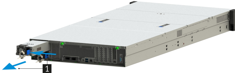
Рис. 74. Извлечение блока питания сервера
