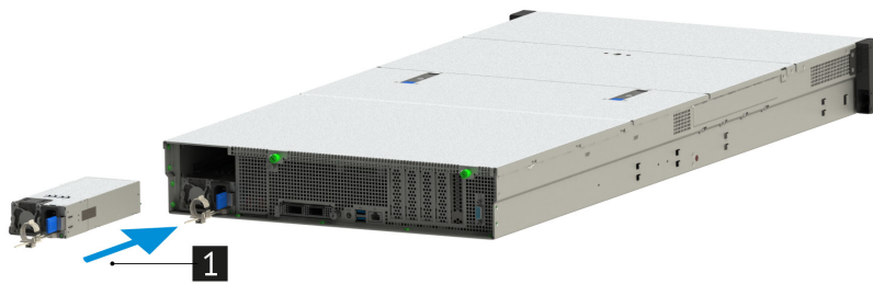
Рис. 73. Установка блока питания в сервер
