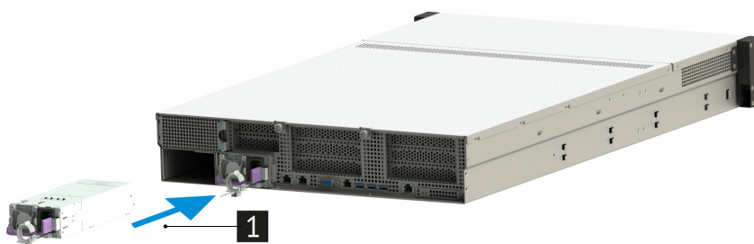
Рис. 61. Установка блока питания в сервер
