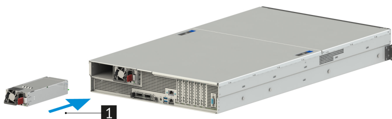
Рис. 64. Установка блока питания сервера
