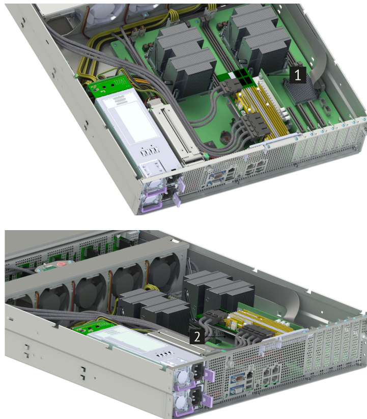
Рис. 42. Расположение райзера PCIe x16-x16 и аккумуляторной батареи в сервере
