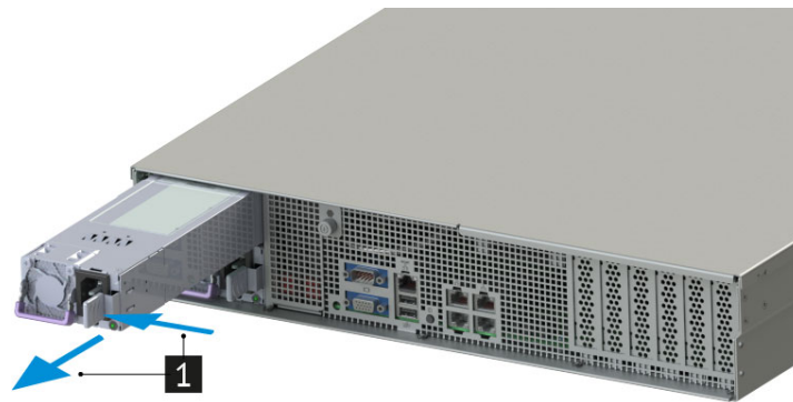
Рис. 48. Извлечение блока питания из сервера
