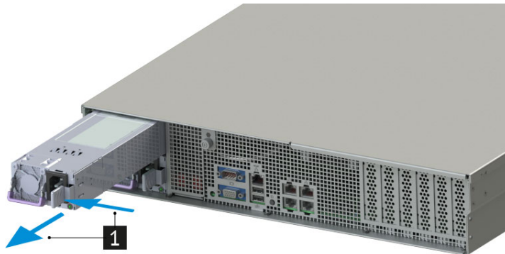
Рис. 50. Извлечение блока питания сервера
