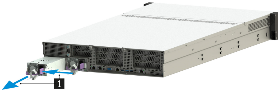
Рис. 60. Извлечение блока питания из сервера
