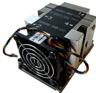
Рис. 38. Радиатор для сервера
