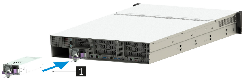
Рис. 63. Установка блока питания сервера
