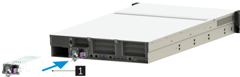
Рис. 61. Установка блока питания в сервер
