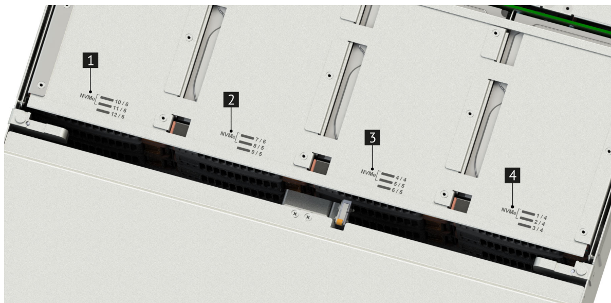
Рис. 60. Место установки NVMe-дисков в сервер
