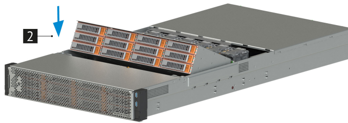
Рис. 30. Установка внутренней дисковой кассеты/поворотной кассеты
