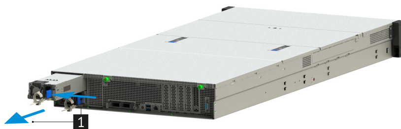
Рис. 72. Извлечение блока питания из сервера
