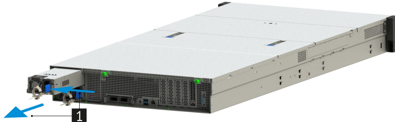
Рис. 74. Извлечение блока питания сервера
