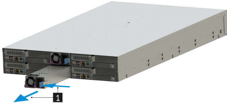
Рис. 94. Извлечение блока питания сервера
