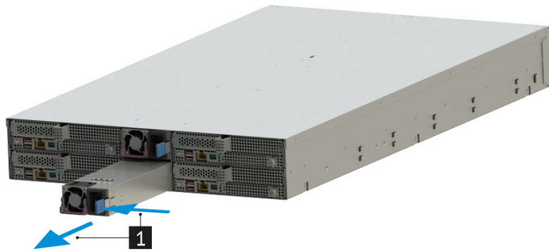
Рис. 92. Извлечение блока питания из сервера
