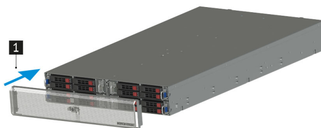
Рис. 32. Установка передней панели с установленными модулями Тип 1
