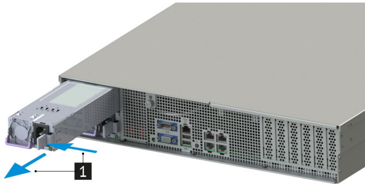
Рис. 50. Извлечение блока питания сервера
