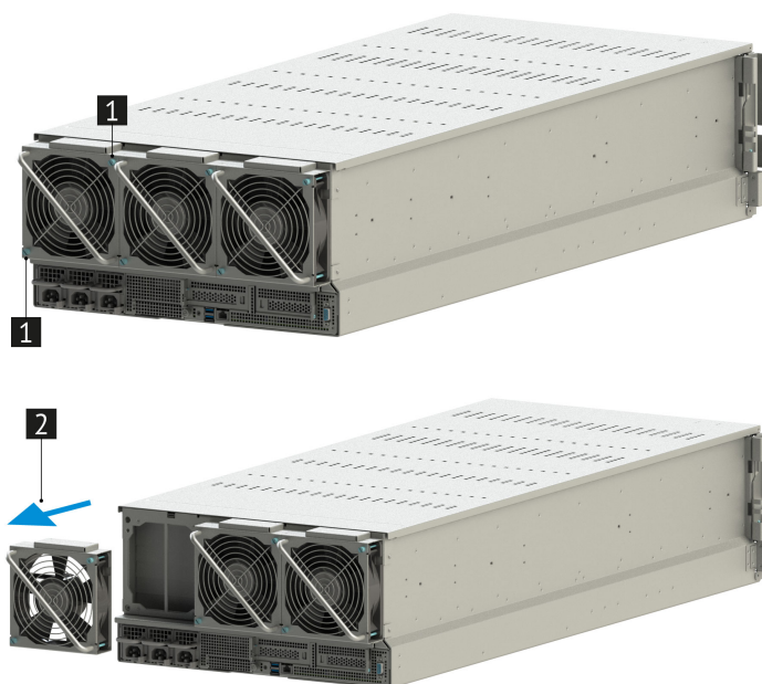
Рис. 31. Извлечение наружного вентилятора сервера
