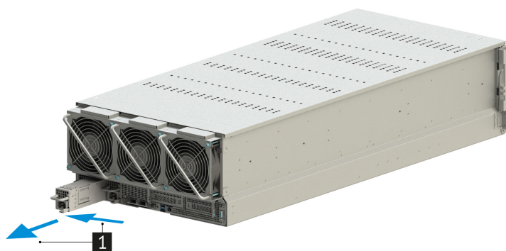
Рис. 58. Извлечение блока питания из сервера
