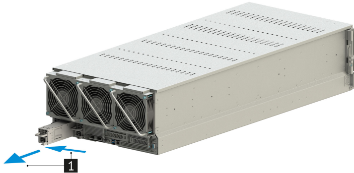
Рис. 60. Извлечение блока питания сервера
