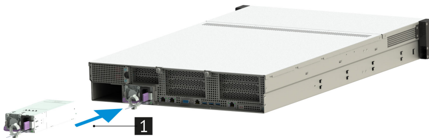
Рис. 63. Установка блока питания сервера
