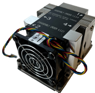
Рис. 38. Радиатор для сервера
