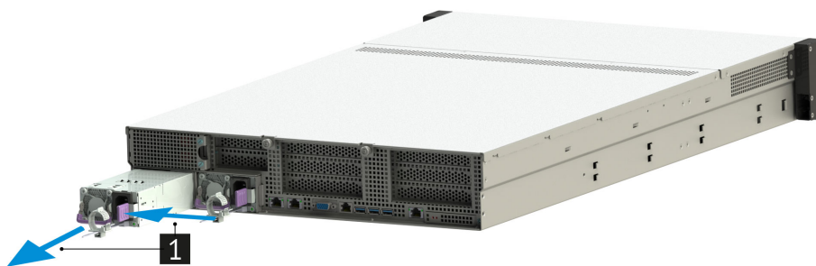
Рис. 60. Извлечение блока питания из сервера
