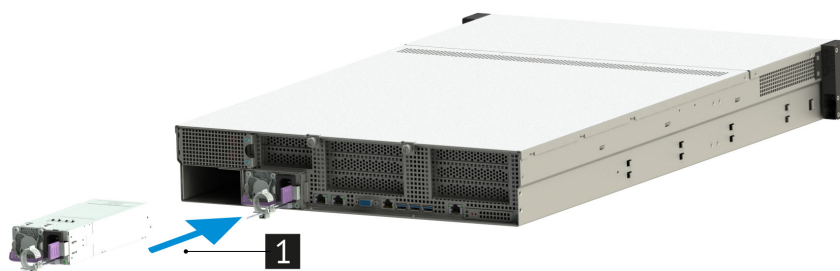
Рис. 61. Установка блока питания в сервер
