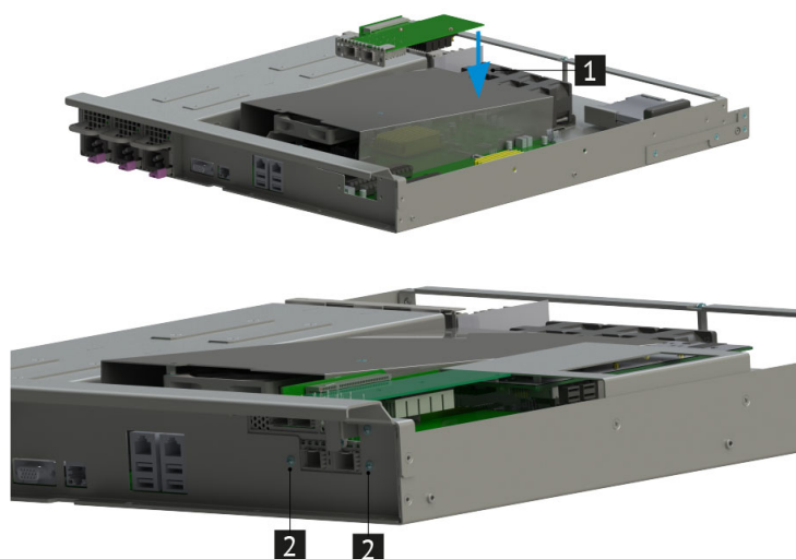
Рис. 49. Установка адаптера поворотного НИКА.469535.019 с картой расширения
