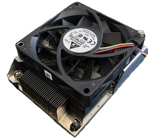
Рис. 35. 1U радиатор с активным охлаждением
