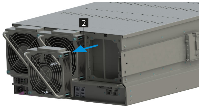
Рис. 28. Извлечение наружного вентилятора сервера
