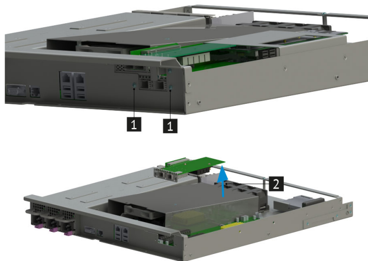
Рис. 48. Извлечение адаптера поворотного НИКА.469535.019 с картой расширения
