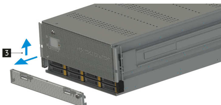
Рис. 15. Снятие передней панели
