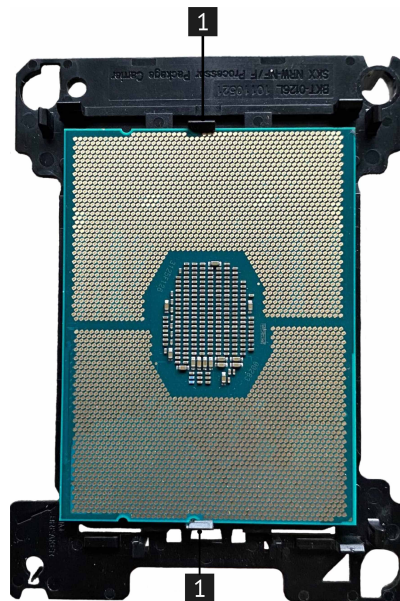
Рис. 38. Снятие процессора с радиатора
