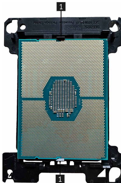
Рис. 38. Снятие процессора с радиатора
