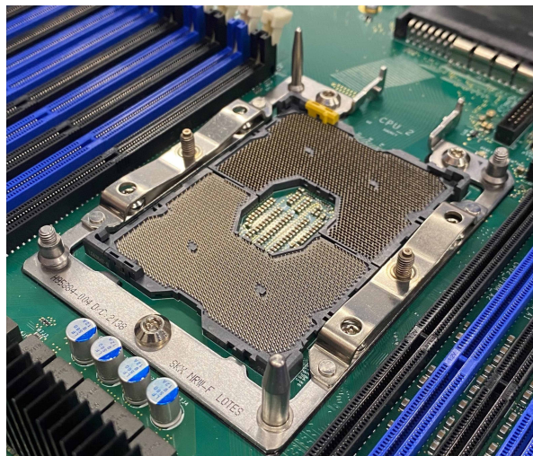
Рис. 36. Снятие модуля процессора с радиатором
