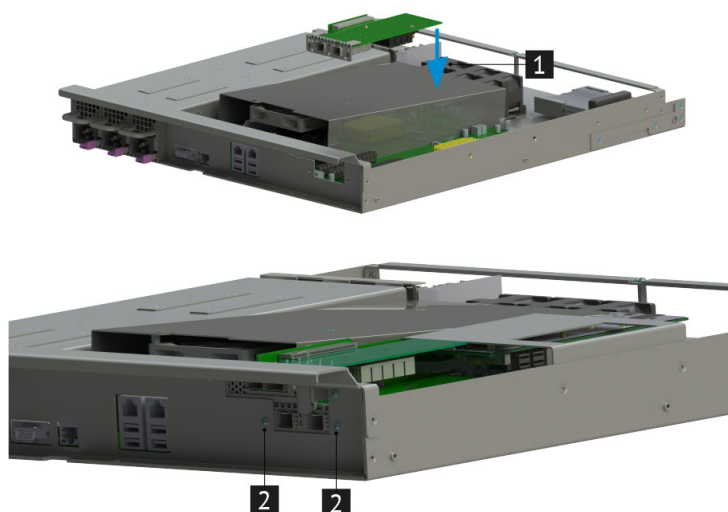
Рис. 49. Установка адаптера поворотного НИКА.469535.019 с картой расширения
