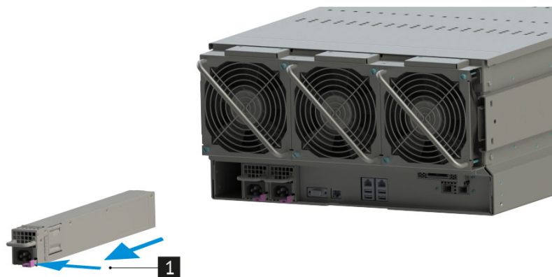
Рис. 55. Извлечение блока питания
