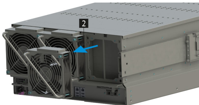
Рис. 28. Извлечение наружного вентилятора сервера
