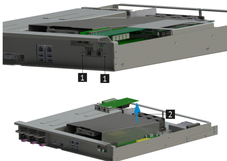
Рис. 48. Извлечение адаптера поворотного НИКА.469535.019 с картой расширения
