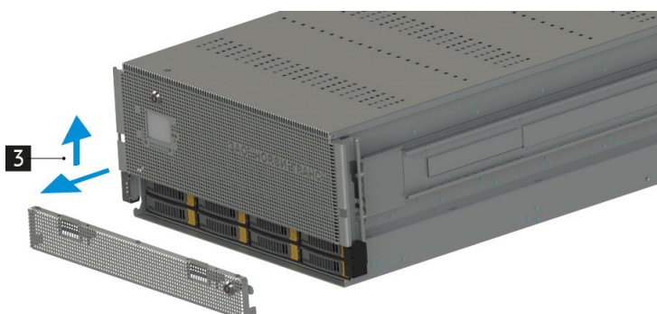
Рис. 15. Снятие передней панели
