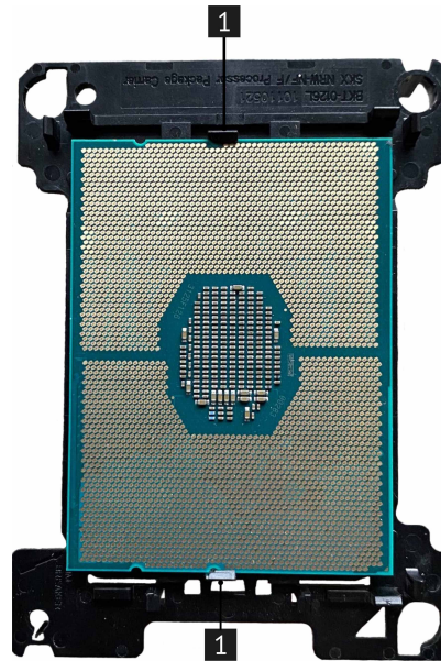
Рис. 41. Снятие процессора с радиатора
