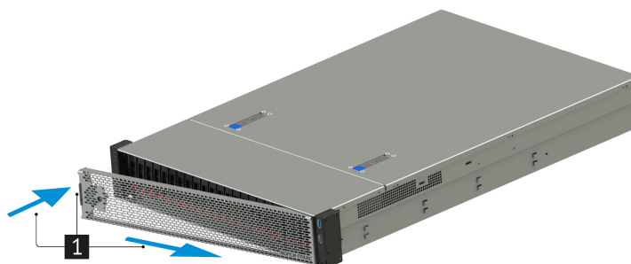
Рис. 20. Установка передней панели
