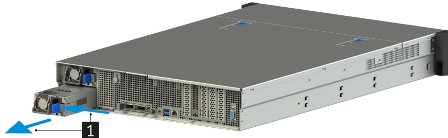
Рис. 63. Извлечение блока питания сервера
