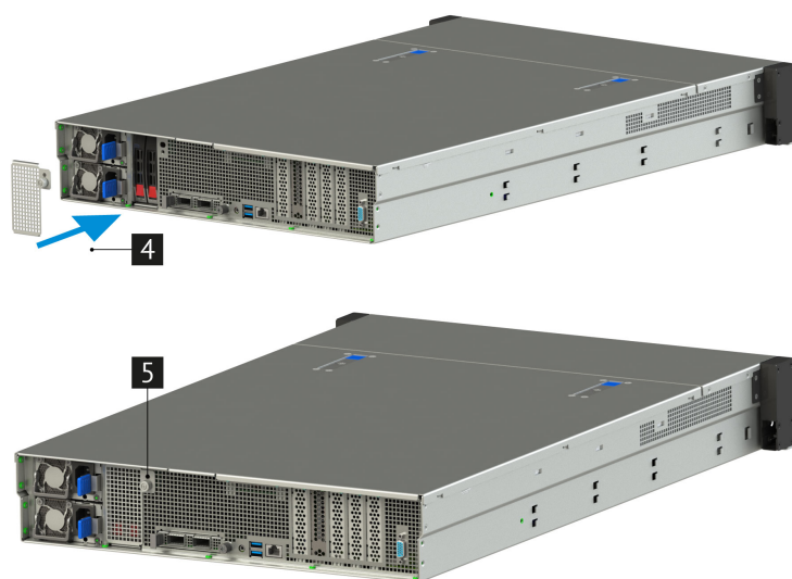
Рис. 51. Установка тыльных дисков
