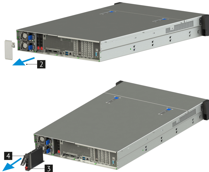
Рис. 50. Извлечение тыльных дисков
