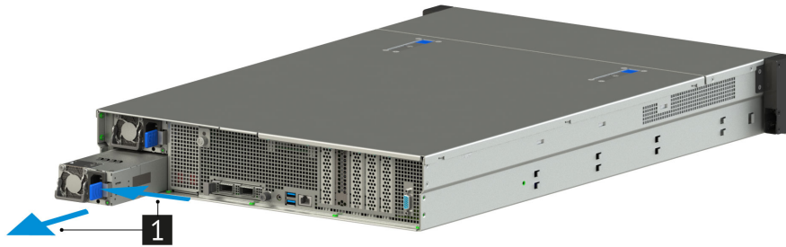
Рис. 61. Извлечение блока питания из сервера
