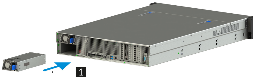
Рис. 62. Установка блока питания в сервер
