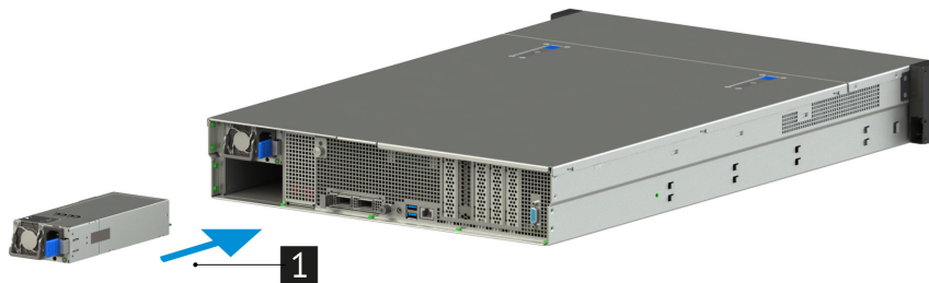
Рис. 64. Установка блока питания сервера
