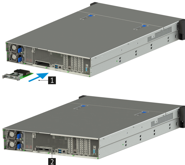
Рис. 59. Установка карты OCP 3.0 PCIe x16
