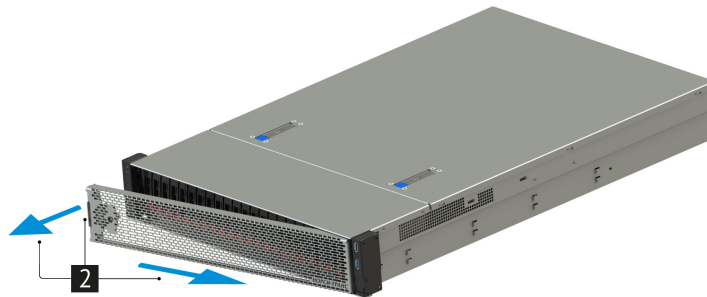
Рис. 19. Снятие передней панели
