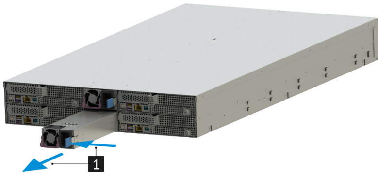
Рис. 92. Извлечение блока питания из сервера
