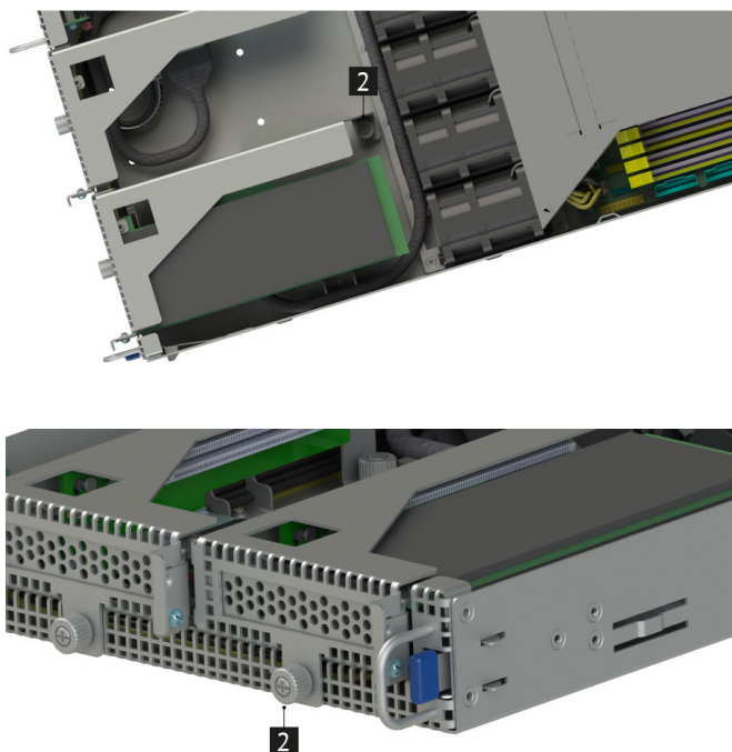
Рис. 80. Установка держателя передних карт расширения с картами расширения
