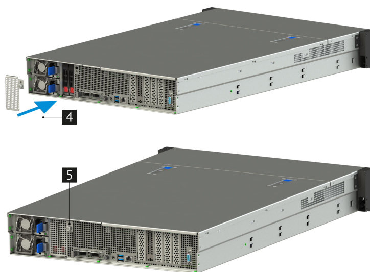
Рис. 51. Установка тыльных дисков
