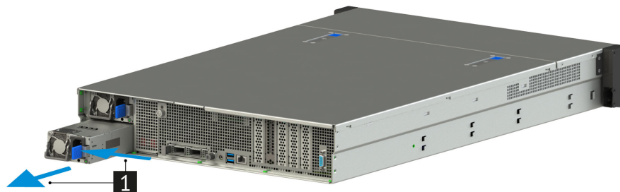
Рис. 63. Извлечение блока питания сервера
