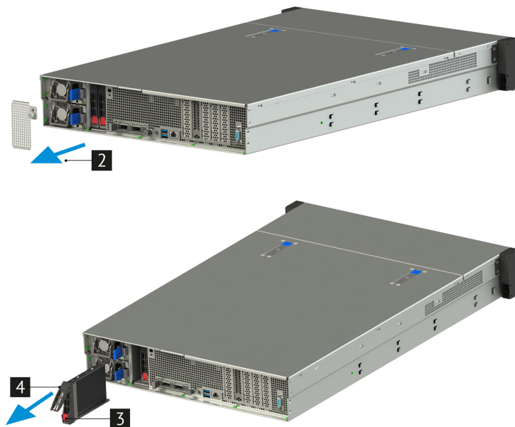
Рис. 50. Извлечение тыльных дисков
