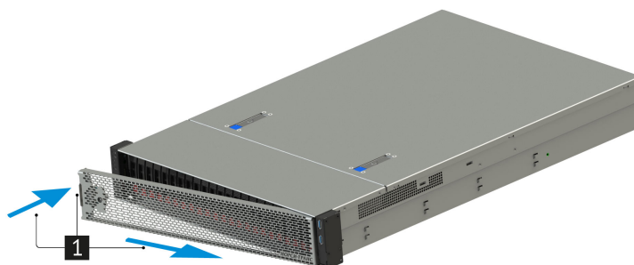
Рис. 20. Установка передней панели
