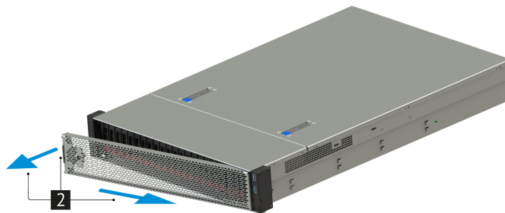
Рис. 19. Снятие передней панели
