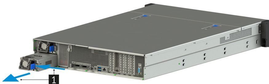
Рис. 61. Извлечение блока питания из сервера
