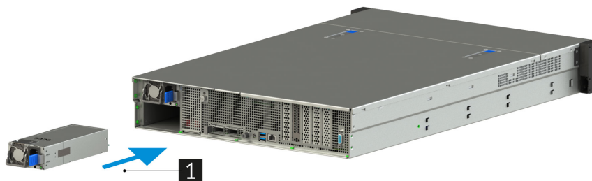
Рис. 64. Установка блока питания сервера
