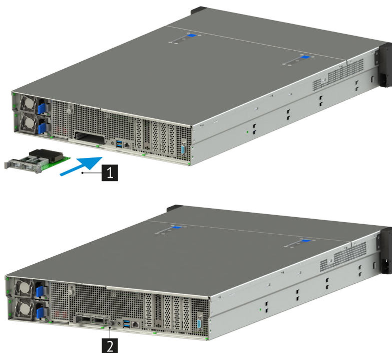
Рис. 59. Установка карты OCP 3.0 PCIe x16
