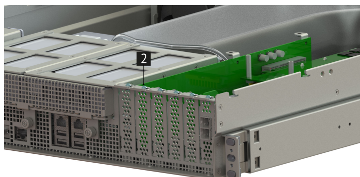
Рис. 51. Установка адаптера поворотного НИКА.469535.023
